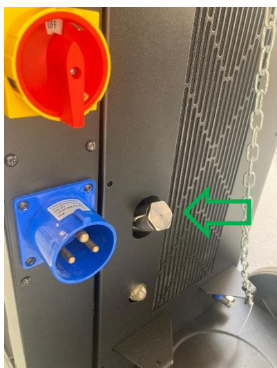
Acceso al depósito (descollar tapón)
